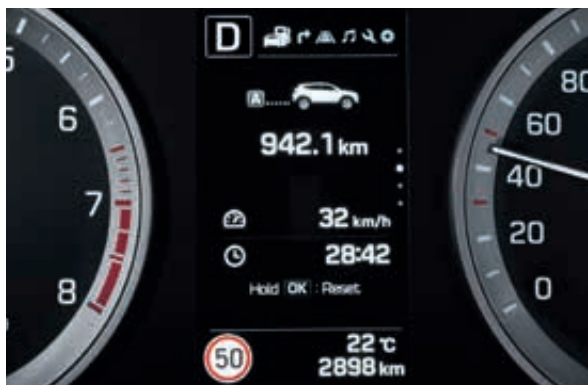
Informování o rychlostních limitech SLIF (Speed Limit Information Function). Systém rozpoznává dopravní značky, porovnává je s údaji v navigačním systému a zobrazuje aktuální rychlostní limit na displeji navigačního systému a na displeji TFT s vysokým rozlišením.
