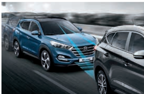
Autonomní nouzové brzdění AEB (Autonomous Emergency Braking). Radarový a kamerový systém FCWS (Front Collision Warning System) upozorňuje řidiče na potenciálně nebezpečnou blízkost vozidel a chodců a v případě potřeby začne autonomně brzdit.
