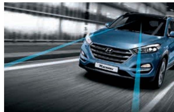
Asistent pro jízdu v jízdním pruhu LKAS (Lane Keeping Assist). Pokud by mělo dojít k nechtěnému vyjetí z jízdního pruhu, LKAS okamžitě reaguje vizuálně a akustickým upozorněním, včetně dočasného aktivního řízení vozu.
