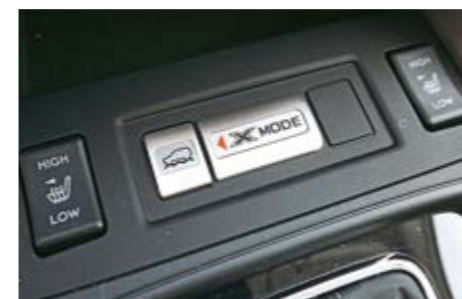
Režim X Mode nastaví motor, převodovku a elektroniku pro provoz v terénu.
